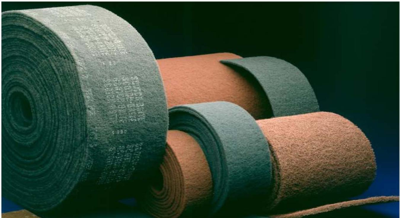
Die TBM Jumbo Rollen werden aus nicht verwebten Nylonfasern hergestellt, die gleichmäßig mit Schleifkörnern durch synthetische Harze, die als Bindemittel wirken, imprägniert werden. Sie sind verfügbar mit Aluminiumoxyd- und Siliziumkarbid-Schleifkörnern. Sie werden in der Originalgröße oder in Streifen in den gewünschten Abmessungen geliefert.
